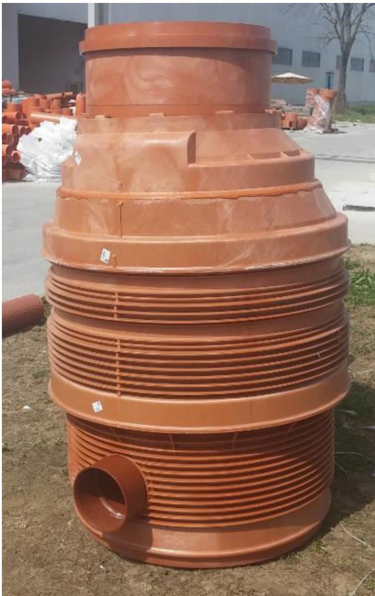
**Montirani šaht od injekciono livenog polipropilena sa spojenim osnovom, produžnim prstenom i teleskopskim nastavkom.**
