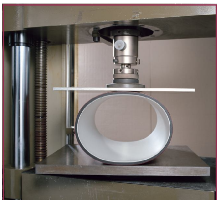
PP MASTER pri 15% deformacije
