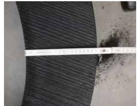
Cev tvrdih zidova od polietilena s = 180 \text{ mm}
