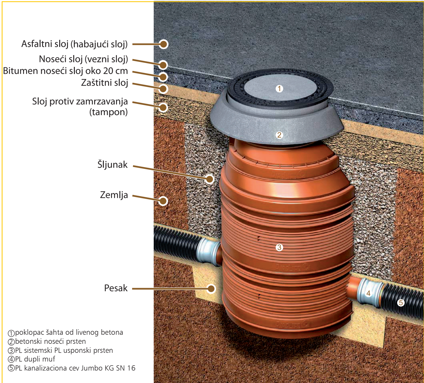
Primer izgradnje kanalizacionog sistema PIPELIFE dn 800 / dn 1000
