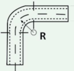
Tokom instalacije PP-R cevi može doći do potrebe da se cevi zakrive. Krivljenje cevi se vrši putem prethodnog zagrejavanja fenom (nikako otvorenim plamenom). Dovoljno je pre krivljenja cev zagrejati do 140°C a preporučeni minimalni radijusi savijanja su dati u tabeli.
