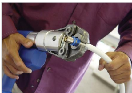
4. Podešavanje pres mašine – žlebovi fitinga treba da uđu u brazdice mašine
